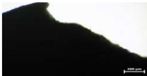
Рис. 13. Мікроструктура нерівностей поверхні h = 22 \pm 11 мкм вихідного мінералу цеоліту \text{Ca}[\text{Al}_2\text{Si}_4\text{O}_{12}]x2\text{H}_2\text{O} до завантаження у фільтр
