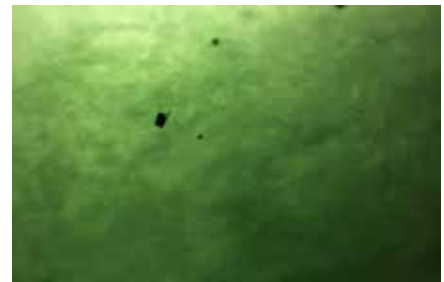
Рисунок 5. Сплутано-волокниста структура у нефриті
