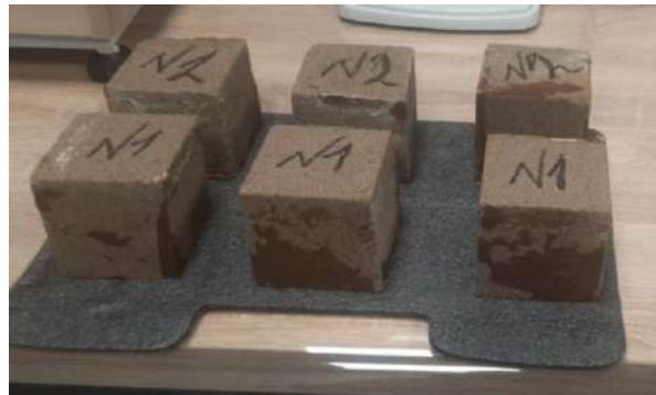
Рис. 2. Геополімерні зразки, що випробовували на міцність
