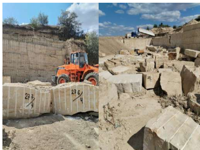
Рис. 3. Фрагмент однієї зі стінок кар'єру та блочна продукція з нього
